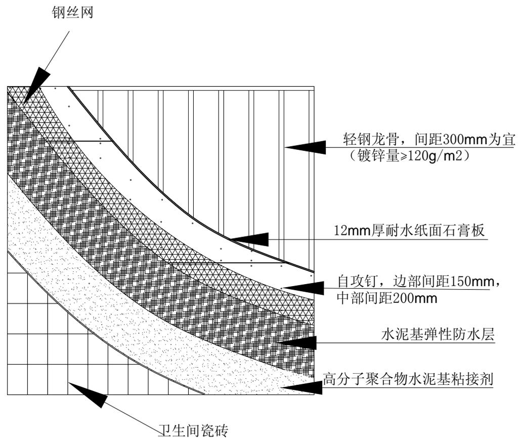
耐水墙系统贴瓷砖示意图
